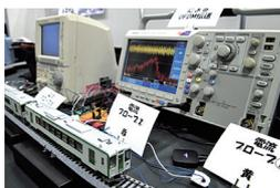
日本の鉄道では、列車制限速度を超えた場合に自動ブレーキをかける自動列車制御(ATC)システムなどによって高い安全性を確保しています。本研究では、本システムの高機能化を実現する通信方式を提案し、実際に組込みシステム用デバイスによる開発を行っています。
