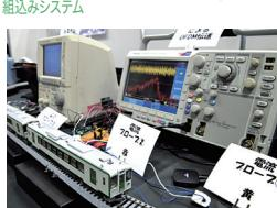
日本の鉄道では、列車制限速度を超えた場合に自動ブレーキをかける自動列車制御(ATC)システムなどによって高い安全性を確保しています。本研究では、本システムの高機能化を実現する通信方式を提案し、実際に組込みシステム用デバイスによる開発を行っています。
