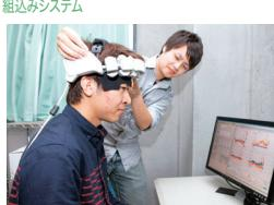
脳科学とテクノロジーを融合したブレインテックの研究をしています。具体的には、NIRSを使って脳内の血液中のヘモグロビン濃度変化から脳活動を推定し、記憶力の解明や感性工学および安全工学への応用などを目指しています。
